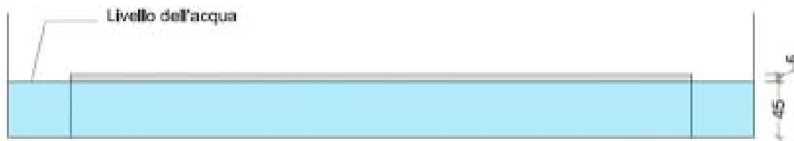
Figura 3: schema della prova per assorbimento d'acqua alla pressione atmosferica.
