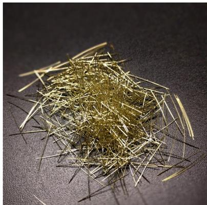
Caratteristiche tecniche delle fibre in acciaio ottonato READYMESH MR di Azichem Srl:
