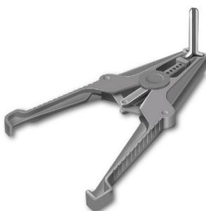
Installazione delle guarnizioni rettangolari RINGSEAL L19, in posizione centrale rispetto ai distanziatori di cassero metallici a lama per cassature in legno, mediante specifica pinza dilatatrice RINGSEAL PINZA K4 di Azichem Srl
