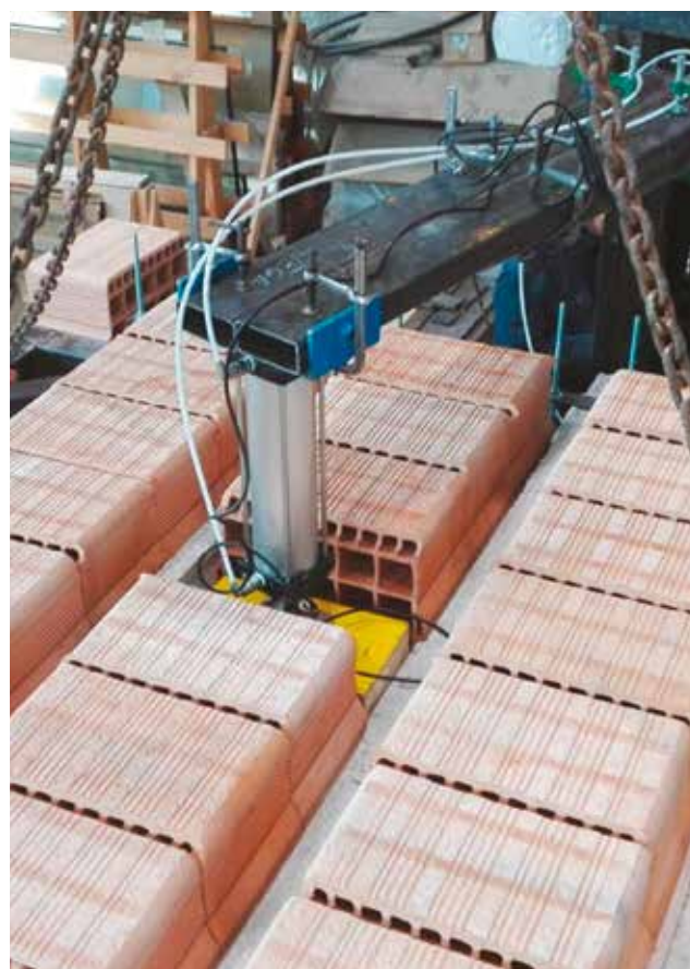
Prova di carico di un sistema di contenimento con rete in fibra di vetro e malta fibrorinforzata.
