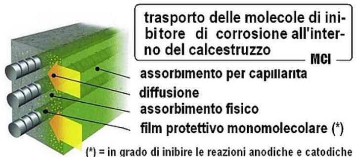
Il film di protezione fissato è funzionalmente attivo anche quando il calcestruzzo nel quale le armature sono immerse è carbonatato e/o quando alla superficie delle armature stesse, il contenuto di cloruri è tale da raggiungere e/o superare la soglia critica.
