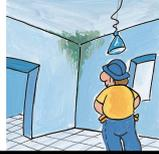
**6** Dopo qualche ora dall'applicazione del fissativo, applicazione la specifica pittura termoisolante, igienizzante, anticondensa **PROTECH THERM**, a base di termopolimeri acrilici in emulsione acquosa, microsferi di vetro cave, pigmenti, cariche lamellari, inibitori di corrosione, per un consumo indicativo di 0,25-0,35 kg/m<sup>2</sup>.
