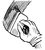
NB: la quantità di **PROTECH THERM** da applicare deve consentire il conseguimento di uno spessore minimo efficace non inferiore a 300 micron (0,3 mm)
