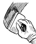
NB: la quantità di **PROTECH THERM** da applicare deve consentire il conseguimento di uno spessore minimo efficace non inferiore a 300 micron (0,3 mm)
