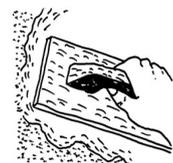
**8** Realizzazione dello strato di finitura, mediante applicazione a frattazzo, dello specifico intonachino rasante, traspirante, bioedile, **SANASTOF**, per un consumo indicativo di 4 kg/m<sup>2</sup>. Attendere minimo 21 giorni (a 20°C) per l'applicazione delle pitture traspiranti.
