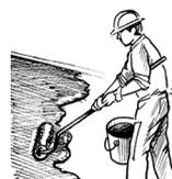
**4** Applicazione, mediante pennello, rullo o spruzzo (airless), in due mani, della finitura epossidica in emulsione acquosa **SYNTECH PAVICROM**, specifica per condizioni di traffico medio/leggero, nella pigmentazione preliminarmente definita. Consumo indicativo per due mani = 0,20-0,25 kg/m<sup>2</sup>.
