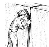
**5** Infine sigillare le zone impermeabilizzate mediante l'utilizzo di stucchi cementizi, sigillanti specifici e/o quant'altro possa occorrere per riportare il manufatto al precedente aspetto. Nel caso di giunti, ovviamente, aver cura di non completare la copertura dell'elemento di contrasto con malte o prodotti rigidi, che naturalmente impedirebbero al giunto di svolgere la sua funzione.
