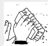
**2** Sigillatura, ove necessario, delle fessurazioni, mediante applicazione, a spatola, dello specifico stucco elastico, autoadesivo, fibrorinforzato **FIBROSTUCK**, a base di leganti acrilici in dispersione acquosa, fibre polipropileniche, agenti specifici, farine ed aggregati silico-calcarei, per un consumo indicativo di 1,75 kg di prodotto per litro di sigillatura.
