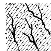
**5** Applicazione a finire, in due mani, date a rullo, pennello o spruzzo, della specifica pittura atossica, traspirante,, pigmentata, ad adesione e struttura microcristallina **SANAXIL P**, a base di silicato di potassio stabilizzato, data tal quale, o diluita con **SANAXIL FIX** (15-20% in peso).
