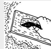
**6** Realizzazione dello strato di finitura, mediante applicazione a frattazzo, dello specifico intonachino rasante, traspirante, bioedile, **SANASTOF**, per un consumo indicativo di  $4 \text{ kg/m}^2$ . Attendere minimo 21 giorni (a  $20^\circ\text{C}$ ) per l'applicazione delle pitture traspiranti.
