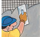
**6** Realizzazione dello strato di finitura, mediante applicazione, a frattazzo, dello specifico intonachino rasante, traspirante, bioedile, **SANASTOF**, a base di calce idraulica, per un consumo indicativo di 3-4 kg/m<sup>2</sup>. Attendere almeno 21 giorni per l'applicazione delle pitture.
