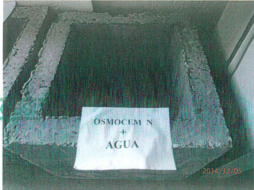
Deposito impermeabilizzato con il sistema I: Osmocem N+Acqua potabile.
