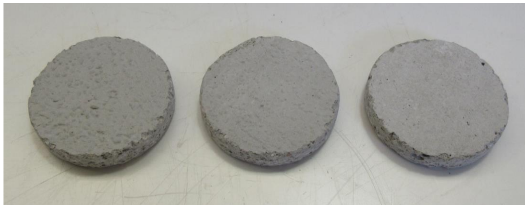
Figura 2. Provini per la misura di conducibilità termica.
